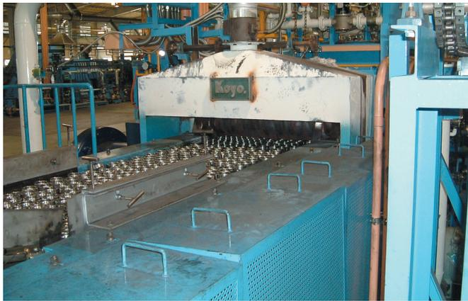
↑軸受部品の熱処理工程
