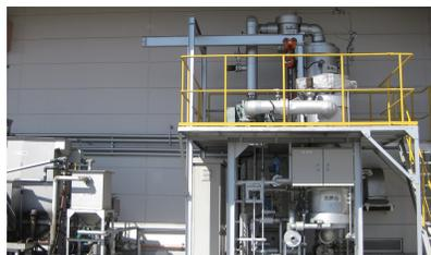
↑ヒートポンプ式真空蒸発装置
