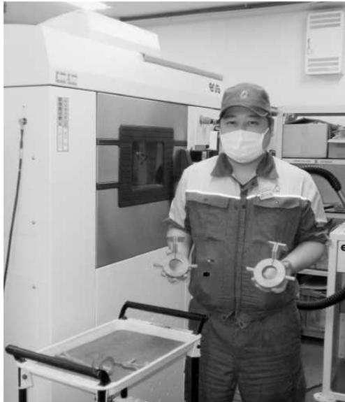
温室効果ガス排出を低減した。コイル破損の原因となることが多かった口ウ付け箇所が減って耐久性が向上し、ユーザーにも喜ばれている」と話
