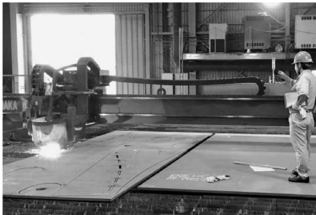
電極の交換のため切断途中で中断しなければいけないことをユーザーは最も嫌う
