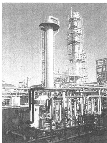
温水型ヒートポンプを用いて省エネを可能にした添加物工場（右が更新した蒸留塔）
