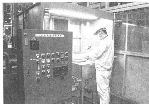
1回では均質な膜を張れない。炉から出しつて、また吹きつけて、炉に入れると、炉の予熱時間が省けられる。炉の開閉で温度が低下するともない。
