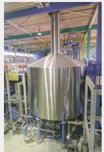
巨大な煮沸釜で消費するエネルギーは、工場全体のエネルギー消費量の約35%を占める
