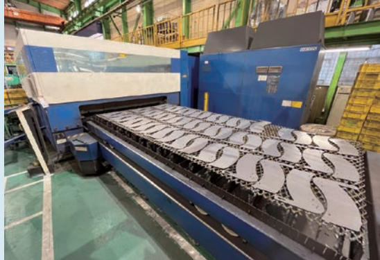
▲ ディスクレーザ加工機による鋼材の切断加工
