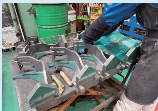
▲ 塗装前のマスキング(緑色の透明なシール)
