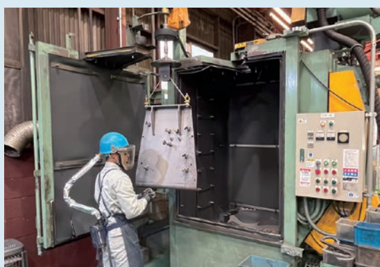
▲ ショットブラストによる素地調整
