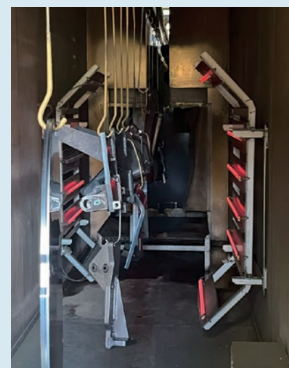
▲ 中赤外線ヒーターで水切り乾燥を促す
