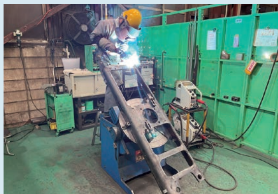
▲ CO 2 自動溶接
