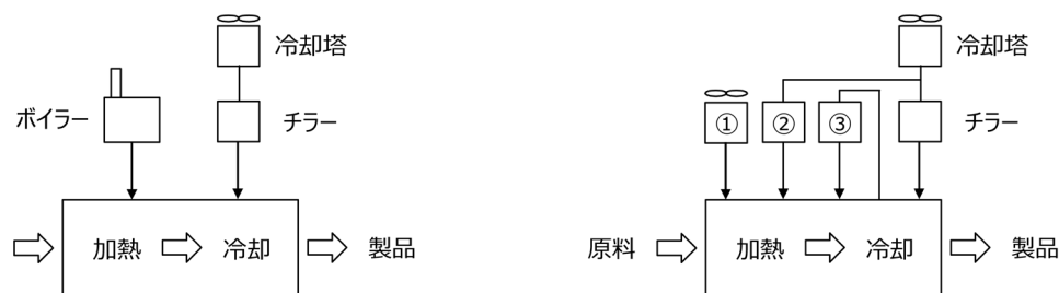
(a) 蒸気ボイラを用いる場合
