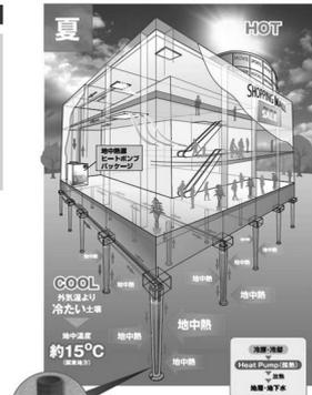
たとえば、建物断熱材の構造を利用して、より簡単に「地中熱エネルギー」を利用する空調設備。そのほか、空気の循環による空気の熱交換方法を検討することで、システム導入をサポートします。
