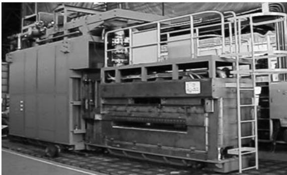
写真1 粗バー加熱装置 (9000 kW—1400 Hz)
