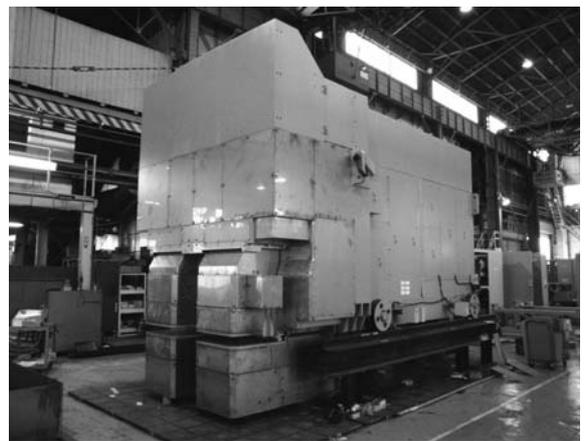
写真2 エッジ加熱装置 (4400 kW—300 Hz, 片側)
