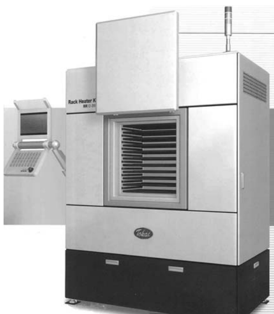
図 1 ラックヒーター炉の外観
