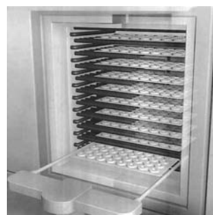
図 2 ラックヒーター炉の処理品積載例
