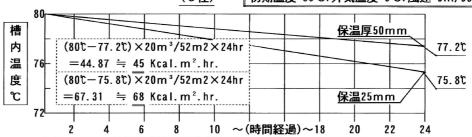
ロ). 実容量 1 0 m³槽の温度変化と単位熱損失 2.1mφX3.2mH=表面積:28m²(呼称:11m³) 初期温度=80℃.外気温度=0℃.風速=表示無し
