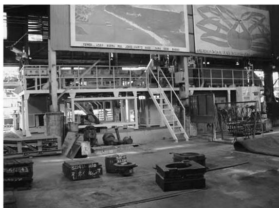
写真1 建機部品向け誘導加熱装置 1,500 kW
