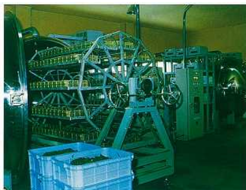
＜図 3＞ 野菜の減圧乾燥装置
