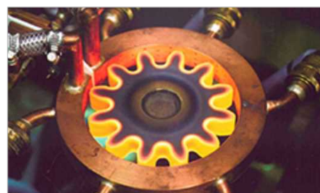
<図 3> ギヤ歯焼入焼戻装置
