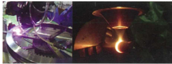
<図 5> レーザー焼き入れの様子
