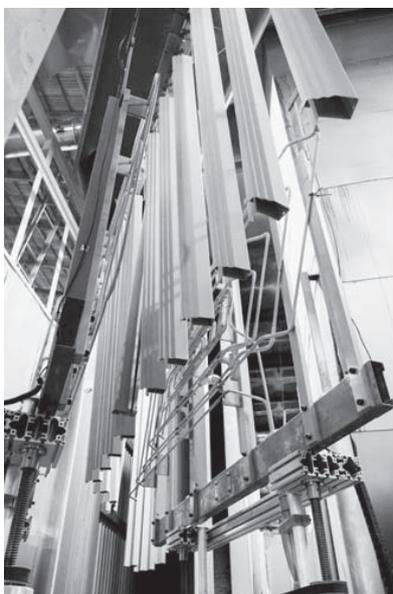
向上を目的に電磁誘導加熱装置を導入した。同工程には長さ100センチのガス式乾燥炉がある。厚手の柱部品の場合、乾燥炉内の温度設定は210度C。部材温度は160度Cを15
