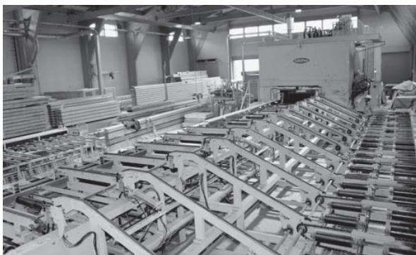
中東（石川県能美市）が本社工場に導入した高周波集成材・CLT接着機
