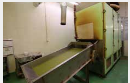
3階に設置されている1号機の遠赤外線かつお節焼軟機。さば節やいわし節などかつお節以外の節を加熱する。
