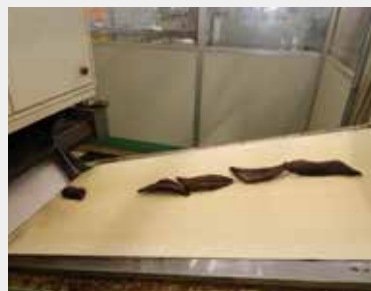
焼軟機の出口。うま味成分が閉じ込められ、香りや風味が向上する
