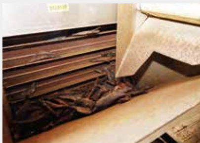
最新型焼軟機の投入口。かつお節がコンベヤネットに載せられ、上下に設置された遠赤外線ヒーターで加熱する
