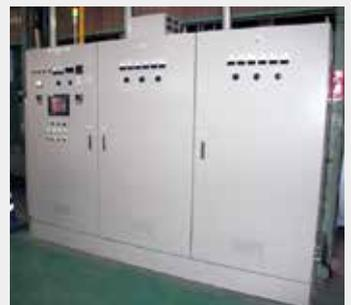
ハイブリッド硬化炉の制御盤
