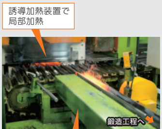
誘導加熱装置とプレス機をローラーで連結し、加熱・鍛造・曲げ加工まで自動搬送できる設計となっている。
