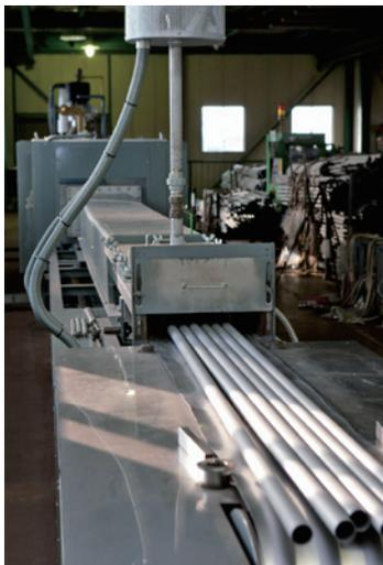
投入口側から見た熱処理工程
