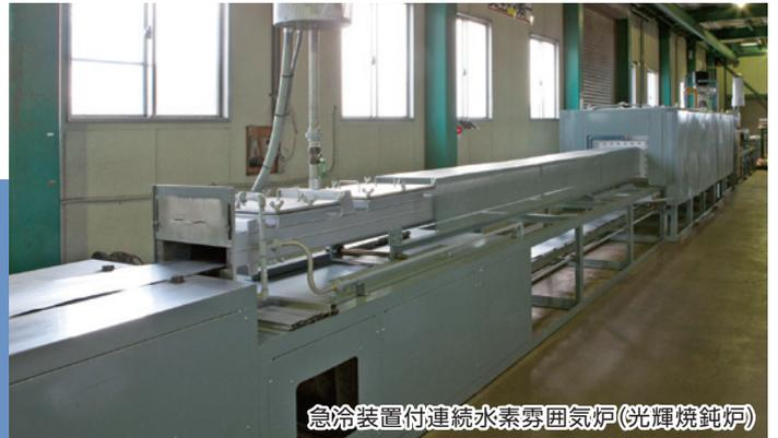
急冷装置付連続水素雰囲気炉(光輝焼鈍炉)
