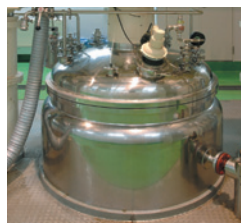
需要に応じた製造量に合わせて調合を行うタンク
