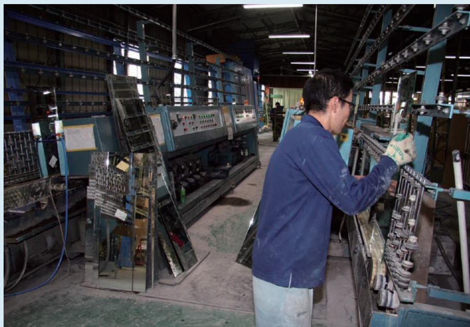
▲ ガラス板を表面・裏面取り、小口研磨加工を行う
