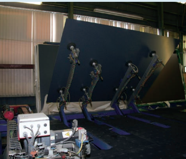
▲ ガラス板を切断機のセット
