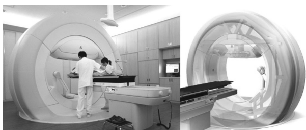
図 1 X 線がん治療装置：三菱重工が開発した装置（VERO）、円環頂部に動態追尾・画像誘導型の小型リニアックが格納（三菱重工ホームページより、 http://www.mhi.co.jp/news/story/1109205107.html ）。
