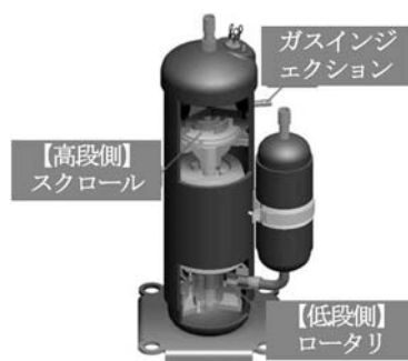
図1 CO 2 二段スクロートリ圧縮機
