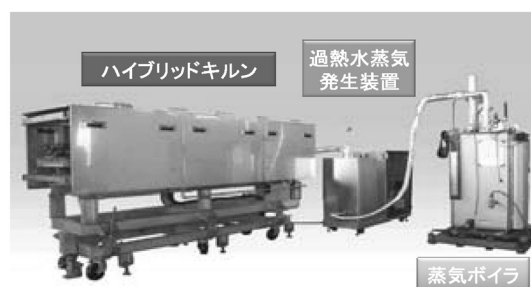
写真1 ハイブリッドキルンの外観写真
