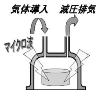
図1 マイクロ波常温乾燥法の原理
