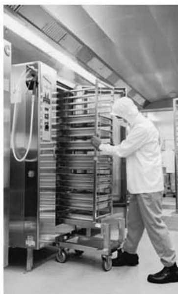
写真 1 天井換気システム 電気式スチームコンベクションオープン
