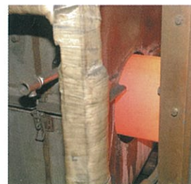
パイプは加熱後、急冷される
